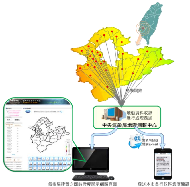
圖 19 本市地震即時觀測作業模式示意圖
