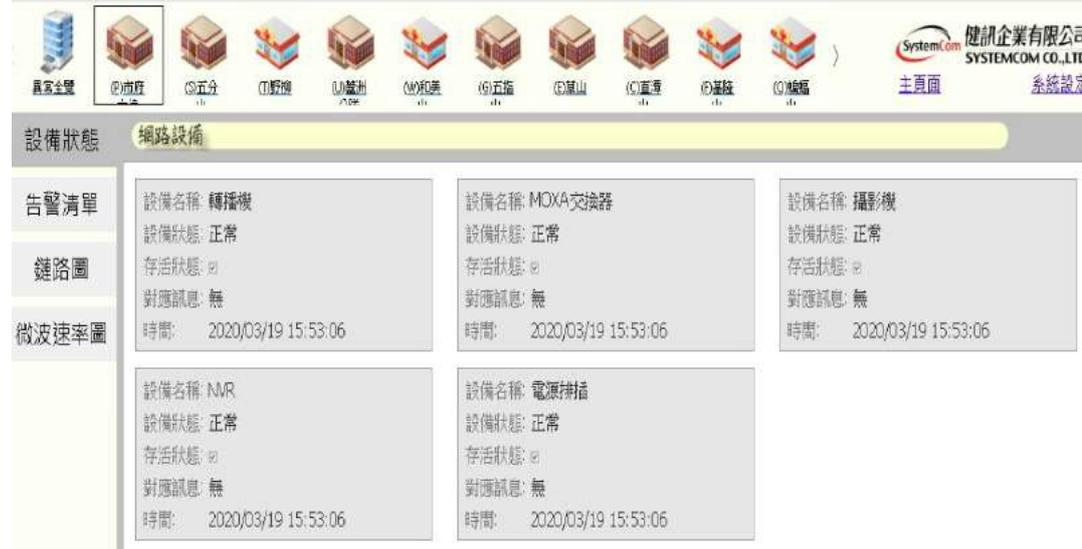
圖-5 本局無線電系統狀態監控畫面
