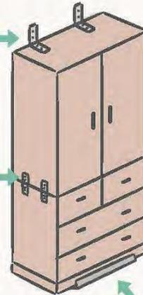
โลหะแผ่นรูปตัว I ยึดติดเฟอร์นิเจอร์ที่มีสองส่วนเชื่อมต่อกัน
