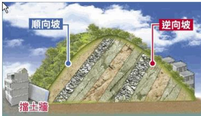
圖 2 順向坡剖面示意圖
