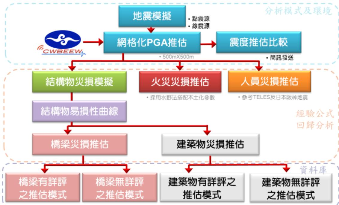
圖 20NTPC-EDAS 災害損失推估流程圖
