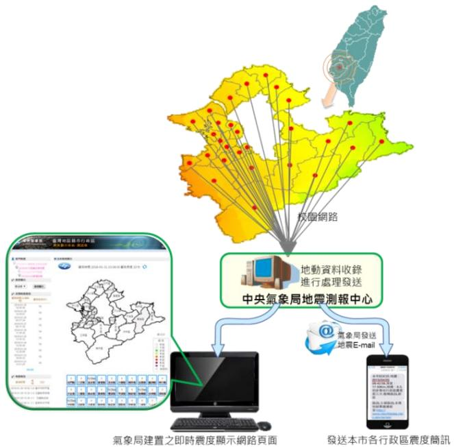
圖 19 本市地震即時觀測作業模式示意圖
